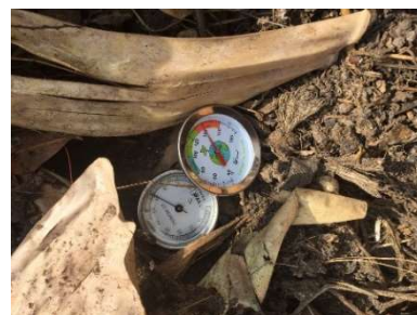
photo.8. Prise de température d'andain à l'aide d'un thermomètre de compostage
